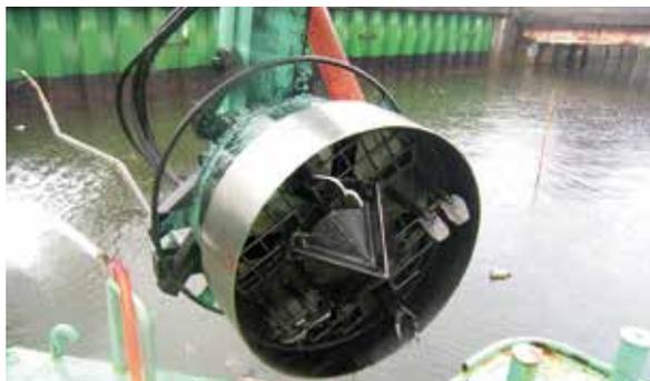
写真-3)バックホウのアーム先端に取り付けられた特殊ドラムアタッチメント
