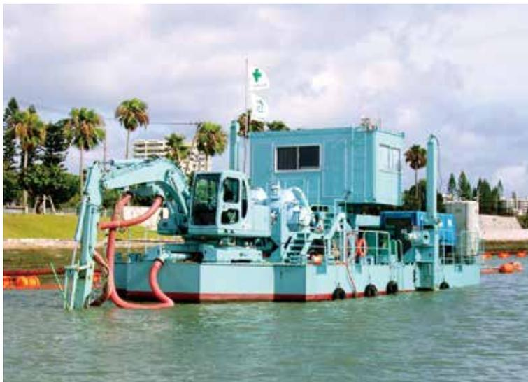
写真-1)真空吸引圧送浚渫工法
