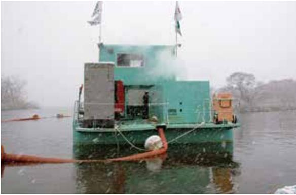
写真-8) 台船の後部より伸びる排泥用の配管
