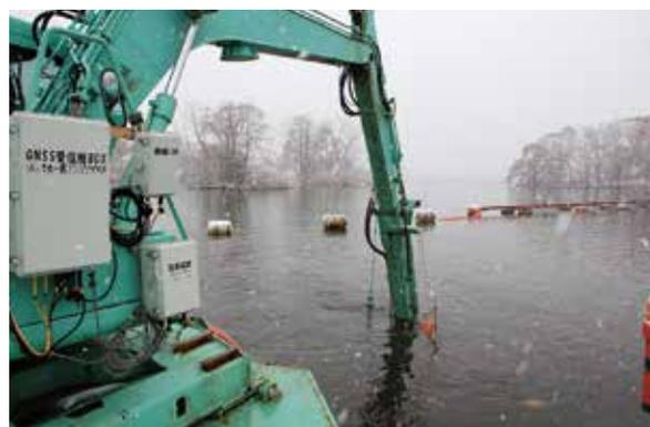
写真-7) 運転席横に設置されたGNSS受信機
